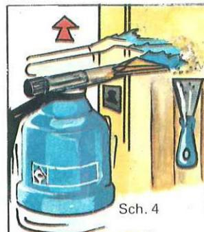
4) - Dès que la peinture ramollit ou cloque, grattez de l'autre main avec le couteau, du bas vers le haut, d'un mouvement ferme du couteau, en appuyant bien sur le support toujours dans le sens de la fibre du bois (sch. 4). Ejectez les copeaux brûlants sur le côté, un peu vers l'arrière.
