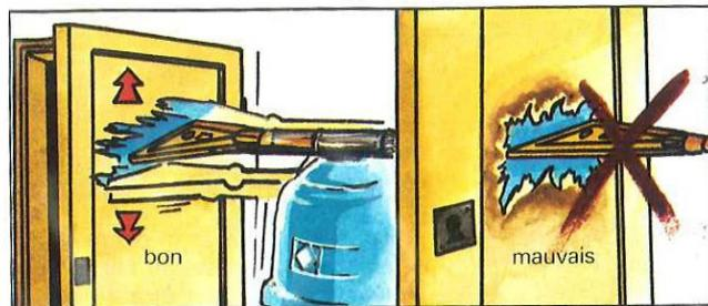
Pour le décapage du bois à la flamme, on gardera toujours la flamme en mouvement de va et vient et c'est le panache de la flamme qui doit lécher le bois et non le front de flamme situé juste à la sortie du brûleur.
